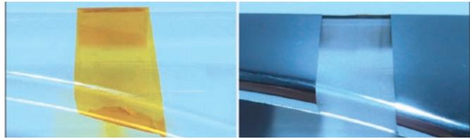
Transparentes PC maskiert mit Kapton-Band, anschließend partiell PVD beschichtet und galvanisiert
