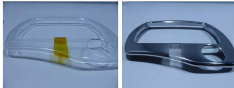
Transparentes PC maskiert mit Kaptan-Band, anschließend partiell PVD beschichtet und galvanisiert
